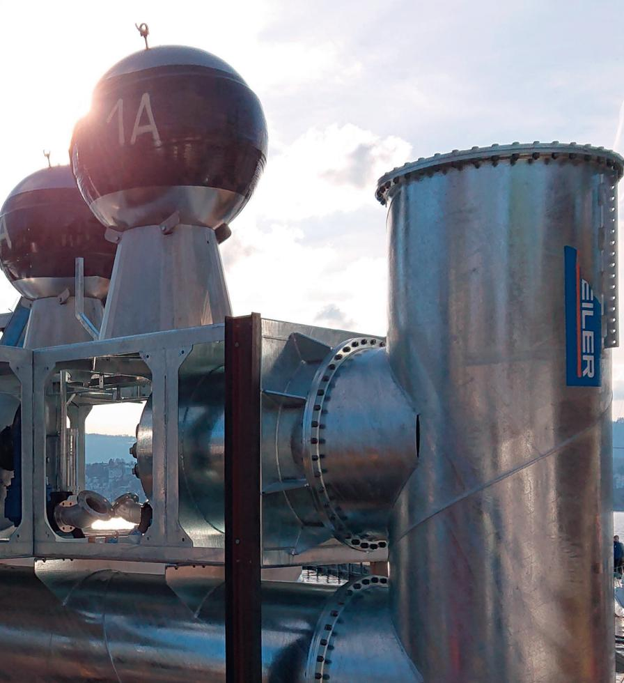
Schwimmeinheit mit drei kugelförmigen Wasserdüsen.
