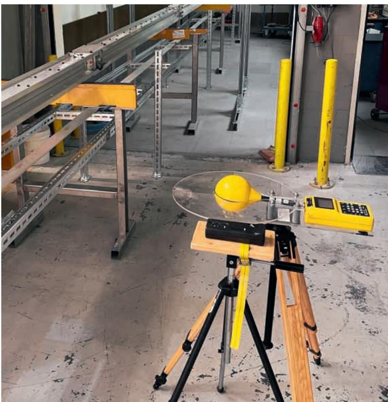
**Messaufbau** Die Stromschiene mit Aluminiumhülle, dem Potenzialausgleichsleiter im Abstand von 30cm sowie dem Messgerät für die Feldstärke.
