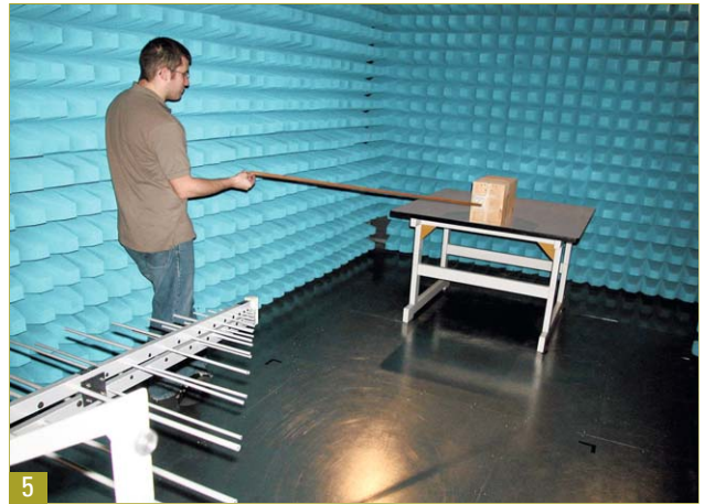
5 BiConiLog Antenne und Hager Funk-Taster WHT390 auf Tisch an Holzklötzchen befestigt, Taster wird mit Holzstab betätigt, Bedientasten gegen die Messantenne gerichtet.
