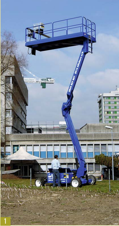
1 Messplattform zur Messung der Magnetfelder der Bahnanlage. 2 Patientenzimmer; gegliedert nach OMEN und SOMEN.
